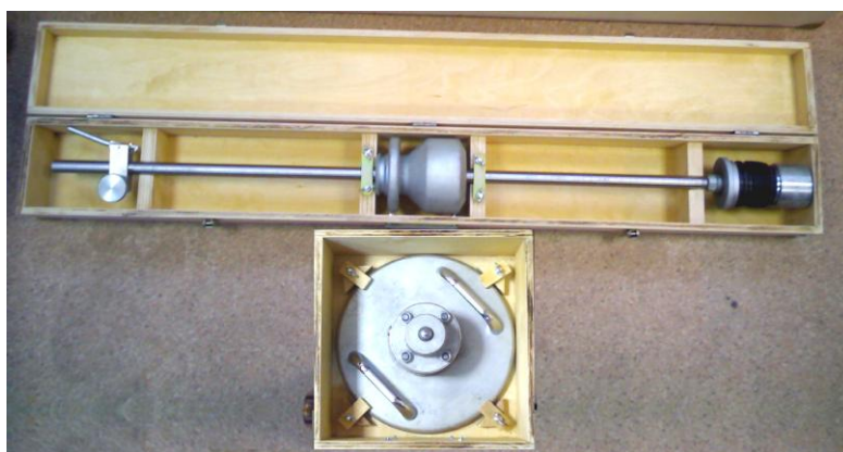
Укладка нагружающего устройства и ПДН в футляр
