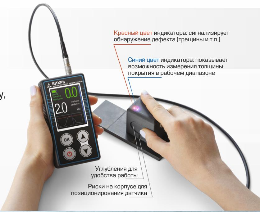
Прибор рассчитан на применение в лабораторных, цеховых и полевых условиях различных отраслей промышленности. Дефектоскоп имеет звуковую и световую сигнализацию при обнаружении дефекта и световую сигнализацию о допустимом диапазоне измеряемого покрытия.
